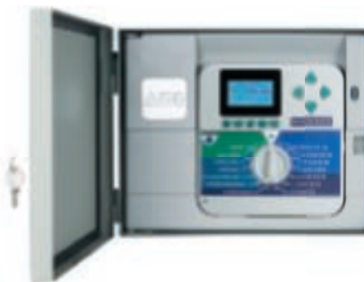
Falra szerelhető, acélházas (porszórással szürkére festve) 31 cm magas, 39 cm széles, 16 cm mély
